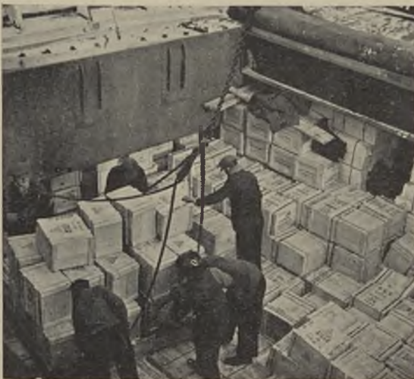
(15) Załadunek skrzynek z szynkami do luki statku przy pomocy platformy (planki) po dociągnięciu hiru, jeszcze zawieszono na haku dźwigu, do najbliższego miejsca rozładowania hiru w luce statku, oraz w chwili odcepienia lin od platformy. Na zdjęciu obok przedstawiono wadliwe piętrzenie skrzynek z pomarańczami w magazynach
