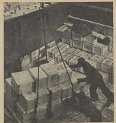
(6) Załadunek skrzynek z szynkami do luki statku przy pomocy platformy (planki) w chwili przyjmowania w luce. Hive jeszcze zawieszony na haku dźwigu i przeciągany przez robotników do miejsca najbliższego rozładowania w luce statku
