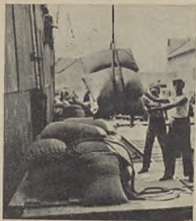
(1) Załadunek ryżu przy pomocy winczy i użyciu sztropów zawieszanych na haku dźwigu. Hive związany jest prawidłowo: niemieszany, zaciągnięty pętlą, sztrop dobity
