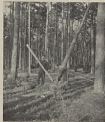
Moment zaczeplenia drzewa przed ściągnięciem go przy pomocy lisicy automatycznej
